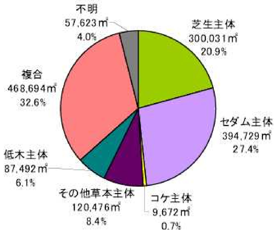
屋上緑化 主な植栽と施工面積（平成12-18年合計）
